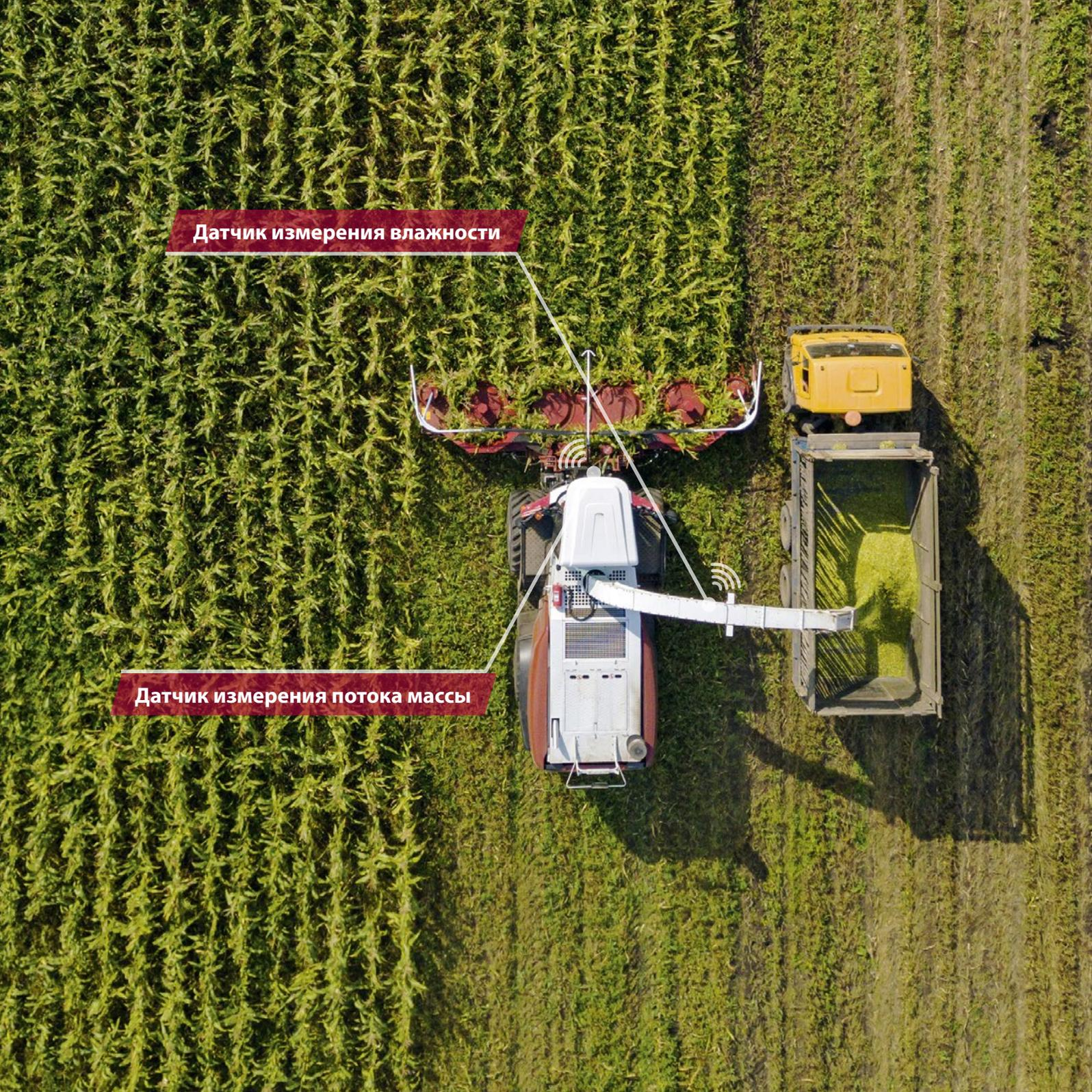
**Датчик измерения влажности**
